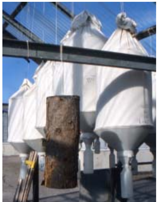
Figur 3. Utläkningsanordning för vedlevande insekter. En stamtrissa el. dyl. hängs upp i ett snöre, och omges sedan av en tygpåse med uppsamlingssträtt i botten. Foto P.O. Hedgren.
