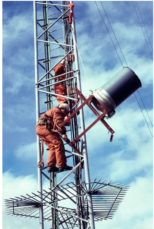
Figur 1. En sugfälla monteras på masten. I botten syns axialfläkten. Fångststruten är inbyggd i det grå plaströret som har en diameter på 50 cm. Foto: Christer Solbreck.
