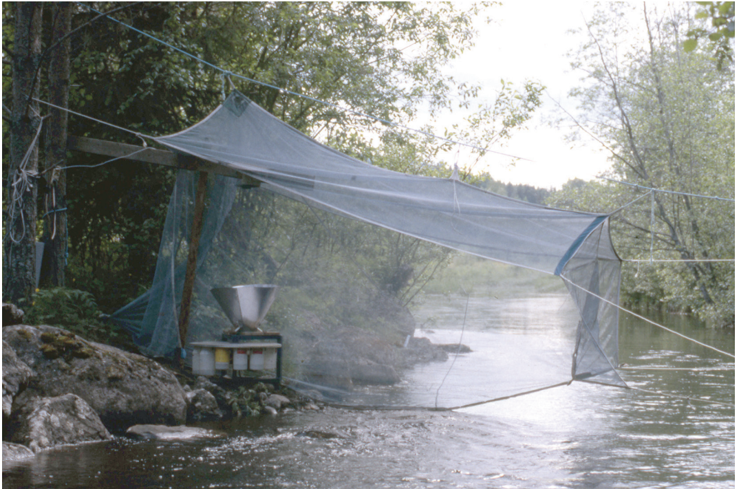
Figur 1. Malaisefälla med automatisk tvåtimmarsväxlare som byter fångstburk varannan timme. The Malaise trap which automatically changes the collectings jars every two hours.
