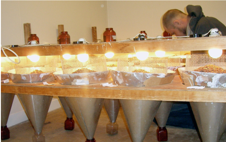
Figur 2. Tullgrentrattar användes för att extrahera skalbaggar både från sällprover och prover tagna med hållproppstagare.
